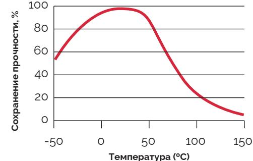
Исследование прочности на сдвиг нагретых поверхностей проводится на образцах из мягкой стали. Клей наносят при комнатной температуре, соединение отверждает в нормальных условиях на протяжении 24 часов.
